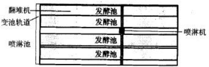
图 6-1 异位发酵床建设示意图
